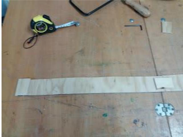
Como quiero que el apoyo de los diferentes vagones se realice sobre una superficie suave para evitar dañar sus superficies, he cortado sendas tiras de Selitac de 50 cms. de una plancha de dicho material que tengo por casa de cuando inicié la maqueta.
